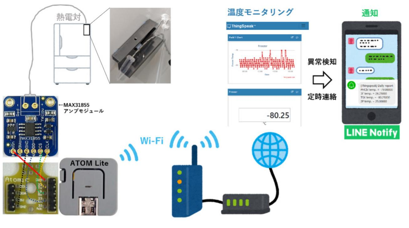
図1 フリーザー温度監視システムの概略図
